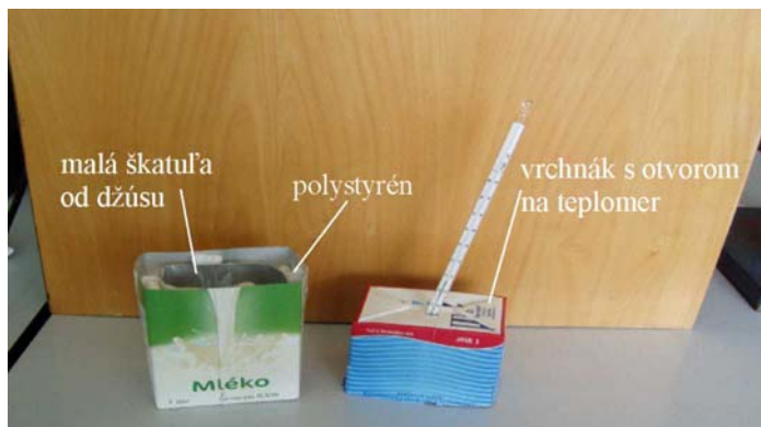
Obr. 1: Principiálna schéma zmiešavacieho kalorimetra (vľavo) a príklad zhotoveného kalorimetra z tetrapakových krabíc (vpravo).
